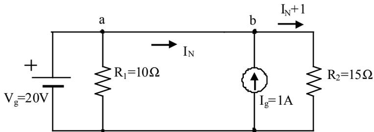
La resistencia  $R_N$  es la misma que  $R_{TH}$ , o sea,  $R_N = 3,75 \Omega$ .
