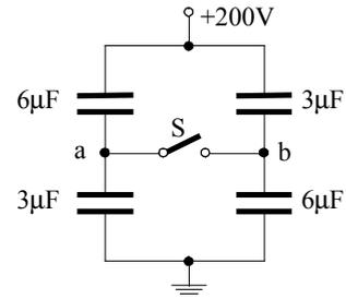
a) Los condensadores  $C_1 = 6 \mu\text{F}$  y  $C_2 = 3 \mu\text{F}$  de cada rama están en serie y su capacidad equivalente es:
