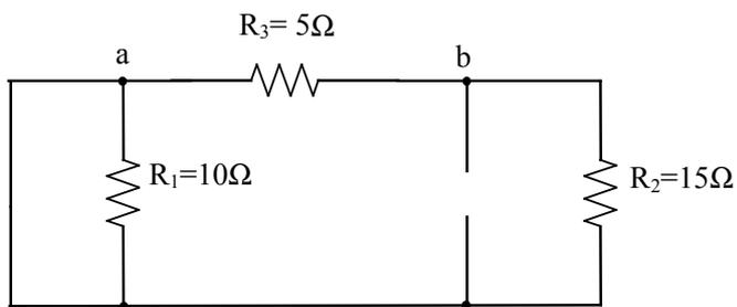
$R_1$  puede eliminarse pues por ella no circula corriente, ya que queda cortocircuitada (la resistencia equivalente entre una resistencia en paralelo con un cortocircuito es cero:
